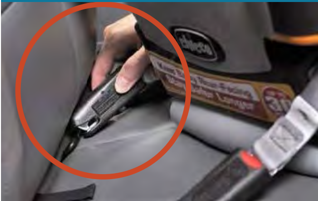
Conector latch que se traba en el anclaje inferior
